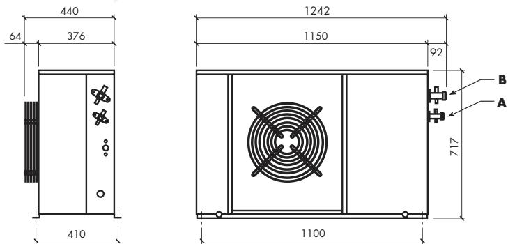
**A**= Tubo linea liquido / Liquid line pipe
