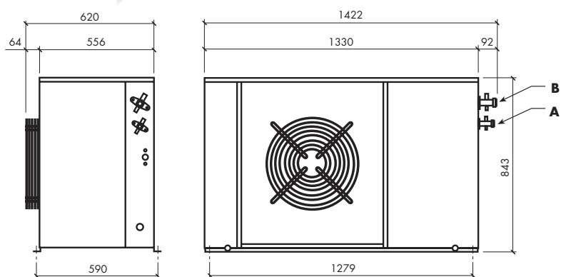
**A**= Tubo linea liquido / Liquid line pipe
